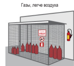
Рис. 10. Хранение технического газа на открытом воздухе
