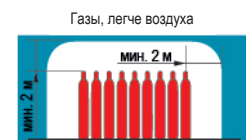
Рис. 8. Измерения охранных зон для баллонов с горючим газом для хранения их в зданиях
