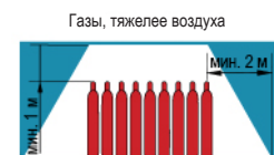
Рис. 9. Измерения охранных зон для баллонов с горючим газом для хранения их в зданиях
