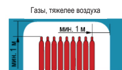
Рис. 11. Измерения охранных зон для баллонов с горючим газом для хранения их на открытом воздухе
